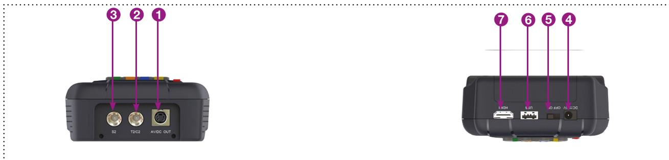
1. Sortie S-Vidéo, permet de connecter le mesureur au moyen du cordon fournit sur un téléviseur externe.
