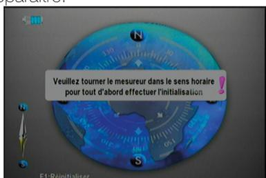
Il vous faudra dans un 1er temps faire tourner le mesureur dans le sens des aiguilles d'une montre pour initialiser la boussole.
