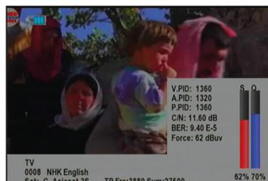
PID audio et vidéo, BER, niveau du signal, nom de la chaîne, nom du satellite et transpondeur.
