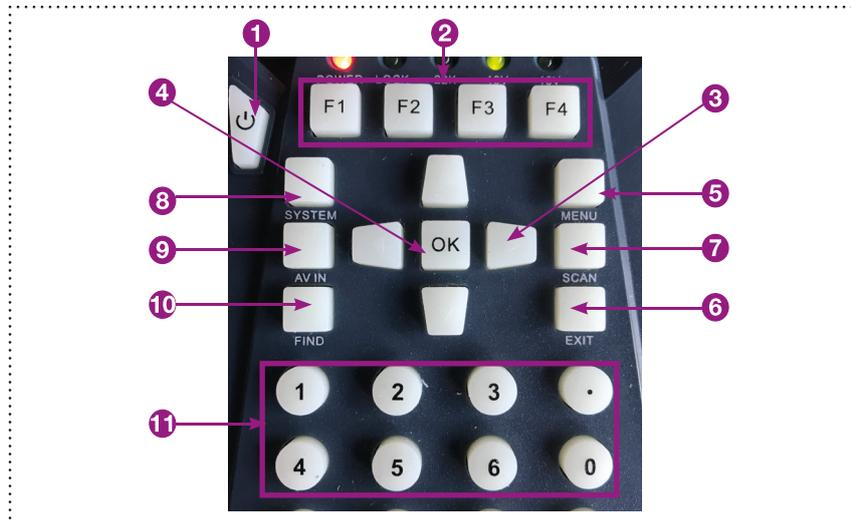
1. Touche «**POWER**» : Permet d'allumer ou d'éteindre le mesureur. Laissez appuyer environ 3 secondes pour l'allumer.
