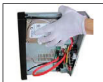
3. Vissez ou dévissez les vis du disque dur
